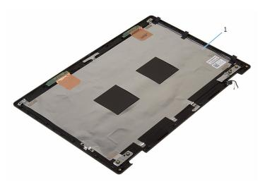
1 assemblage du capot arrière de l'écran et des antennes
