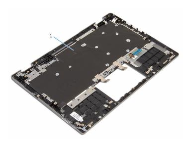
1 assemblage de repose-mains et de clavier
